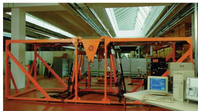
Die computergesteuerte Windlast-Simulationsanlage liefert wichtige Erkenntnisse für die Entwicklung von Flachdach-Befestigungssystemen.
